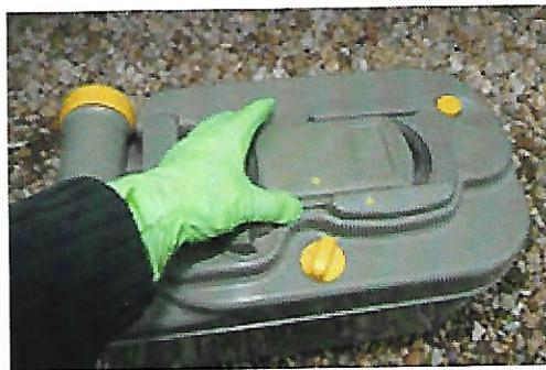
Démonter les cache-guides placés de part et d'autre de la trappe en les déclipant à l'aide d'un tournevis plat. Pour faciliter le remontage, il faut mémoriser l'emplacement du cache marqué d'une flèche jaune.
