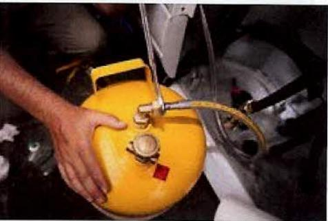
→ Vissez la lyre sur le réservoir en prenant soin d'enduire le cône avec du Loctite. Bien serrer le raccord.
