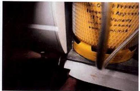
→ Serrez fermement les écrous freinés en intercalant les contre-plaques sous le plancher du coffre.
