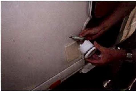
Avant de poser la coupelle de remplissage, il faut déterminer un endroit proche du réservoir et facile d'accès à l'intérieur pour permettre le montage du raccordement.
