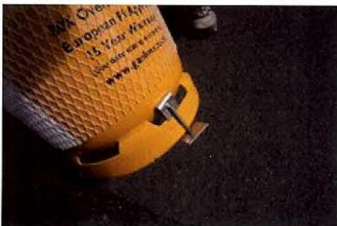
Principe de fixation : Les pattes s'agrippent dans les orifices de ventilation du socle du réservoir.
