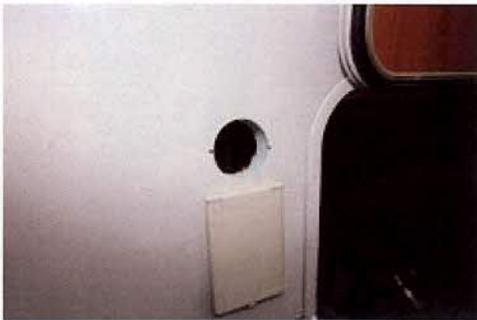
Lorsque l'orifice est percé, tracez l'emplacement des ergots latéraux de maintien de la coupelle.
