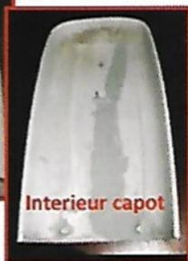
Passer le mélange liquide au pinceau sur l'endroit cassé et poser à l'intérieur la matière plus compacte pour renforcer la pièce. Laisser sécher suivant épaisseur, ( l'Acétone s'évapore et l'amalgame devient rigide) poncer, mastiquer si besoin au mastic de finition, poncer à nouveau et peindre.
