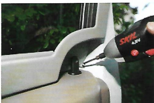
Positionner la cassette devant la vitre, à l'aide d'une visseuse équipée d'un embout en forme d'étoile, serrer chacune des vis. Recommencer de même de l'autre côté. Il ne reste plus qu'à enlever les films retenant les stores puis à faire un essai.
