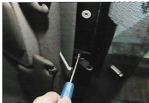
Pour mettre en place le support du bas, fermer les stores de façon à obtenir la bonne distance en les deux guides, décoller l'autocollant, puis serrer les deux vis de maintien en utilisant un embout de visseuse et une clé à cliquet ou une visseuse avec renvoi d'angle.
