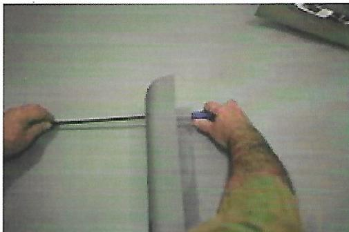
**Fixer les guides** dans les garnitures (sans oublier d'introduire les supports sur la barre des guides). Côté droit, le tube est tenu grâce à une vis ordinaire que l'on visse dans la cheville encastrée dans le guide. A gauche, le guide comporte un pas dans lequel on serre une vis intégrée à la garniture.
