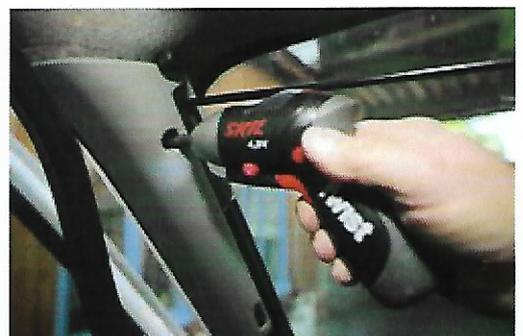
vis de maintien sur la garniture de plafond de la cabine et pour finir, percer avec une mèche de 6 mm.
