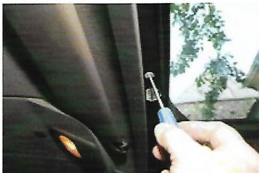
Lorsque les orifices sont percés, fixer les demi parements du haut en le serrant avec les vis en plastique fournies dans le kit. Placer ensuite le parement côté gauche qui vient en recouvrement du précédent.
