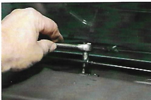
Installation des stores de portières. Les cassettes sont maintenues sur les montants grâce à quatre vis à métaux. Pour fixer ces dernières, il faut présenter les cassettes, pointer l'emplacement des vis puis percer un avant-trou avec une mèche de 2,5 mm.
