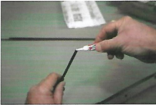
**Préparer les quatre tubes métalliques** formant les deux guides du store. Ces derniers étant de dimensions différentes, il faudra les appairer par morceaux de même longueur. Pour associer les deux parties, utiliser la colle fournie avec le kit.
