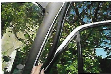
**Mise en place des stores de pare-brise** : pour commencer, vérifier que le kit fourni correspond bien au véhicule. Ensuite, déboîter les joints de portières au niveau des montants de pare-brise de façon à dégager les garnitures de montants.
